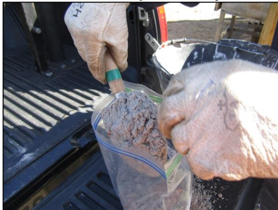
Fotografía 3.3-2 Relleno de bolsa ziploc con muestra compuesta, mayo 2016.
